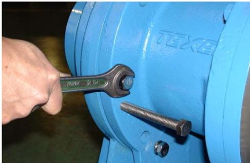
③带着电机、将泵支架（028）移动到可以看到后方内壳（060）的位置。这个时候、可以利用泵支架左右两边附带的拆卸安装用长螺栓、左右均等的拧进将其顶出，注意安全。
